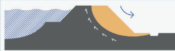
2 Stabiliteit: als er langdurig water tegen de dijk staat, vult deze zich met water en kan de dijk 'slap' worden. Hierdoor wordt deze instabiel en kan bezwijken. Dit gebeurt meestal aan de binnendijkse kant, door de waterdruk vanuit de rivier.
