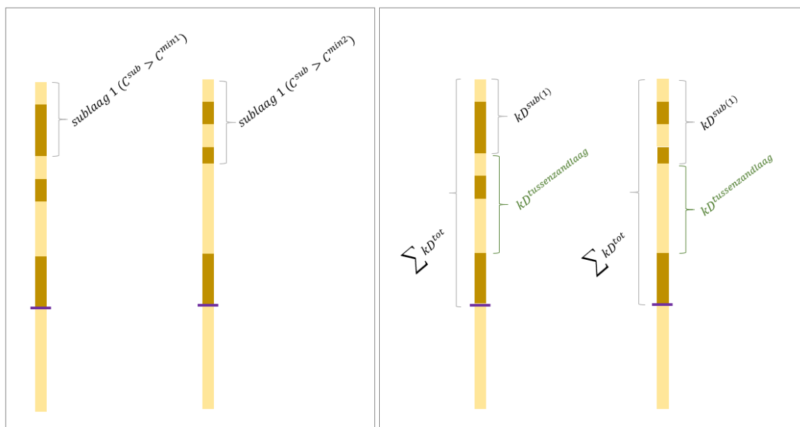
Figuur 2.8 Een schematische weergaven van de gebruikte methode om de kD te berekenen voor de tussenzandlaag in de deklaag. Links zijn twee voorbeelden opgenomen waar op basis van de weerstandsgrenswaardes een sublaag wordt gedefinieerd. Rechts is de weergegeven hoe op basis van sublaag 1 de kD van de tussenzandlaag is berekend. In paars is steeds de onderzijde van de deklaag weergegeven.
