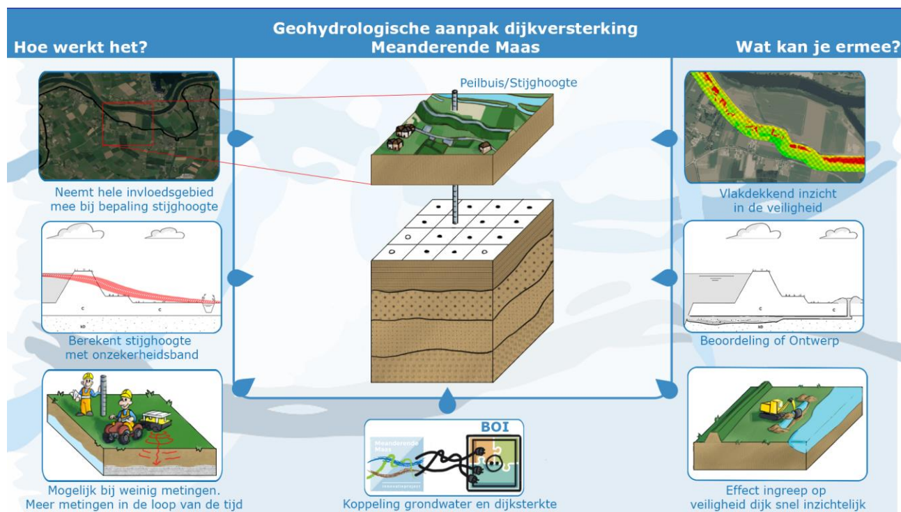
Figure 1: Visuele samenvatting Geohydrologische Aanpak Piping
