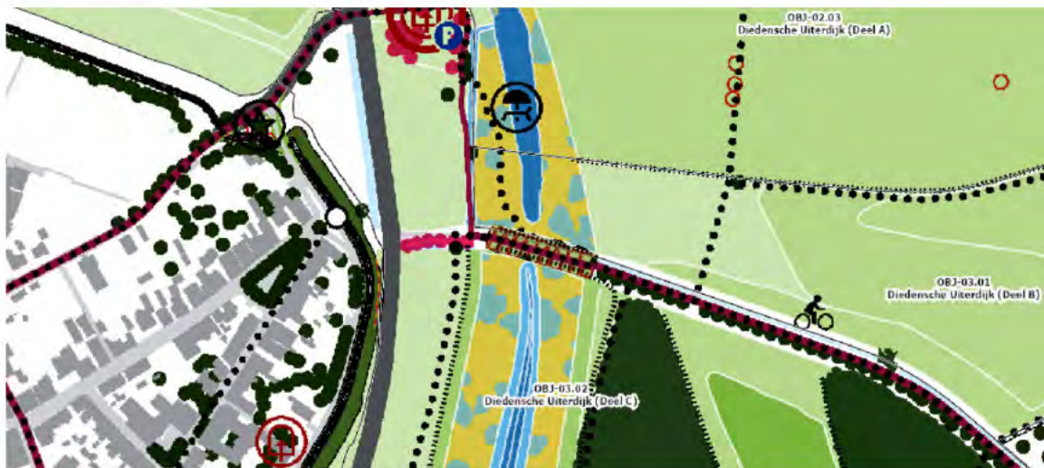
Afbeelding 8.16 Schets van ontwerp waar bomen worden gekapt (rode holle cirkels) en aangeplant (paarse cirkels) in het westelijke deel van de Rulstraat in de Diedensche Uiterdijk
