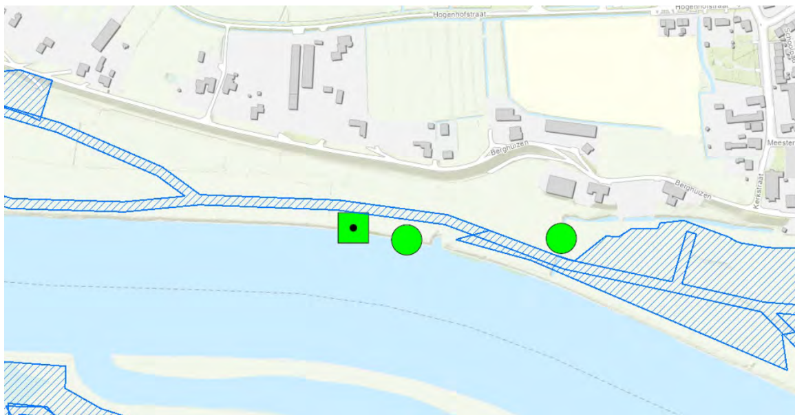
Afbeelding 4.9 Werkwegen en opslaglocaties voor grond (blauw gearceerd) op >20m afstand van dassenburchten (groene cirkel en vierkant, deze zijn ingetekend met een buffer van minimaal 20 meter) bij Maasbommel
