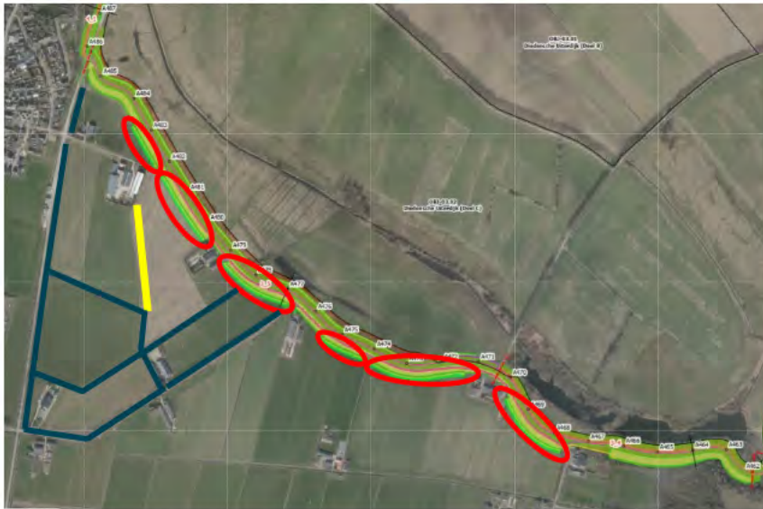
Afbeelding 16.5 Locatie nieuwe teensloten (rood ovaal) voor grote modderkruiper bij water G4. Donkerblauwe lijnen geven geschikte sloten aan waar uitzet mogelijk is als individuen worden aangetroffen bij het afvangen. De gele lijn geeft aan welke sloot voorafgaand aan de werkzaamheden wordt verbreed
