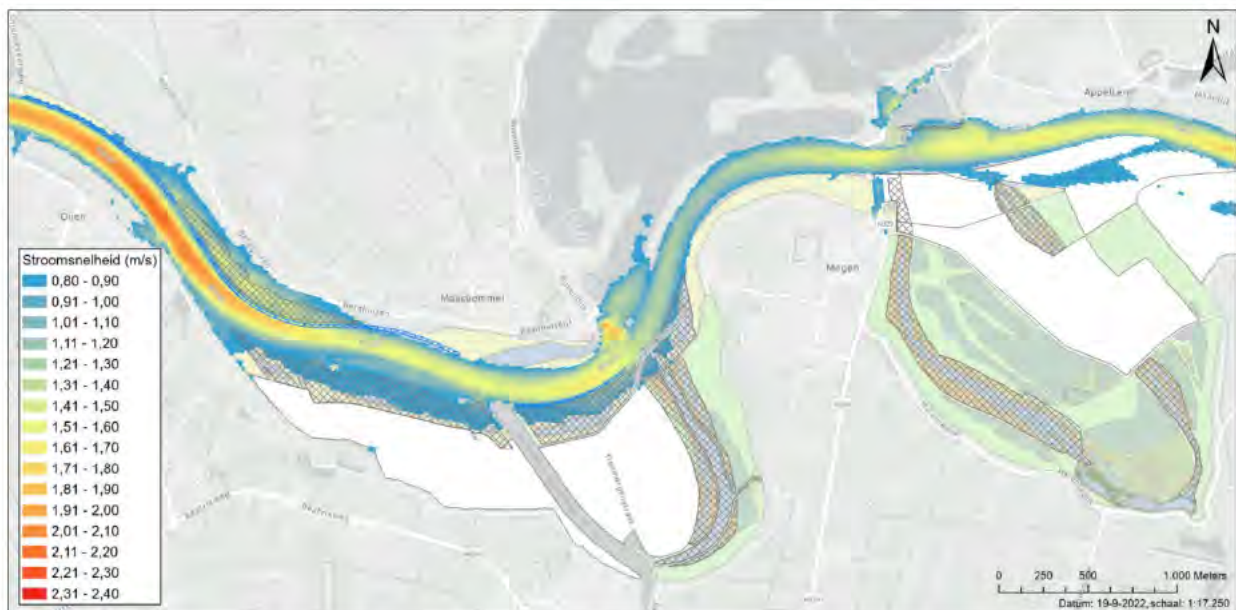
Figuur 7-7: Stroomsnelheden bij een afvoer van 4.118 m 3 /s te Borgharen voor de tussensituatie 'het Werk' van het DO van project meanderende Maas. Stroomsnelheden lager dan 0,8 m/s zijn niet weergegeven.
