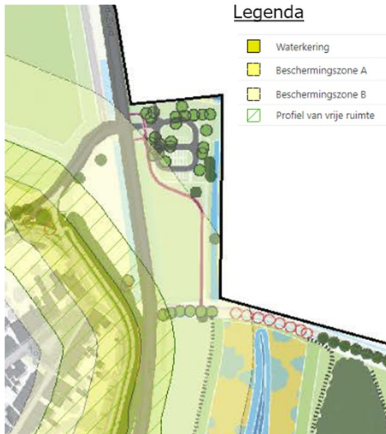
Afbeelding 3.1 Definitief ontwerp Haven Megen met zonering van de waterkering
